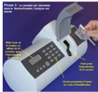
Phase 3 : La cassette est introduite dans le NucleoCounter, l'analyse est lancée
