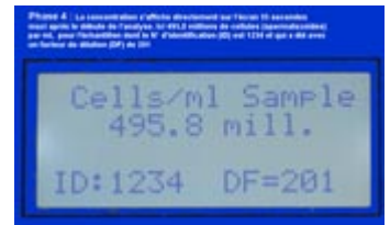
Phase 4 : La concentration s'affiche sur l'écran 35 secondes après le début d'analyse. Ici 495,8 millions de cellules (spermatozoïdes) pour l'échantillon N° 1234, utilisé avec un facteur de dilution de 201.
